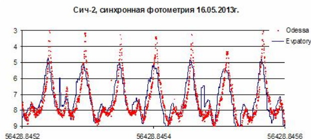
Рис. 4. Пример фрагмента кривой блеска КА «Сич-2», полученный 16.05.2013 г., во время синхронных наблюдений из Евпатории и Одессы (отображаемый интервал: 54 с).
