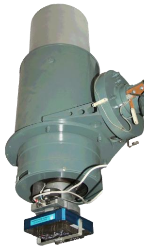
Рисунок 6.3 – Дзеркальний об'єктив системи Максутова.
