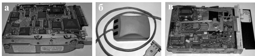
Рис.3. Детали первых ПЭВМ НАО: а) жесткий диск PC-AT на 40 МБ Seagate ST-157A, 1991 г.; б), в) манипулятор “Колобок” и дисковод для ГМД 5.25 Электроника МС-5311 из состава ПЭВМ ЕС-1841, 1992 г.
